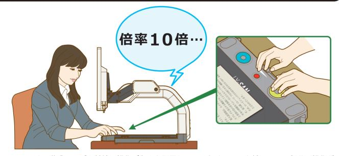
NVS-X1 は可動式テーブル前端に操作パネルを配置しているため、いつも触っている部分で操作ができます。ディスプレイ下部に操作パネルが無いため、ディスプレイを下に下げた状態でも、十分なワーキングディスタンスが確保されます。
