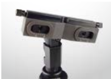
双眼アタッチメント BS-III-BA (BS-III, BS-III LED 専用) 小瞳孔 (2 mm) での立体的観察が可能です。
